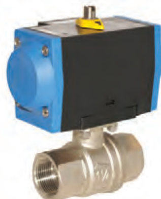
Enkelwerkend - BSP female - NO - veeropenend - kunststof actuator
