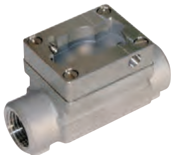
Type S030 - RVS AISI-316L met PVDF peddelwiel - PN16 - BSP female
